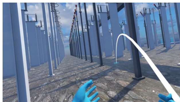
Figura 5. Ambiente de subestações de energia elétrica com destaque para o raio de teletransporte, utilizado para auxiliar na movimentação do usuário no ambiente virtual.
